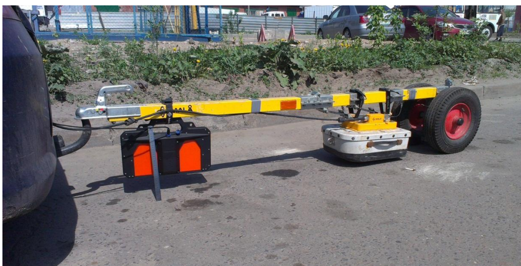
Рис. 3. Крепление прототипа модуля Пикор-2 в новом корпусе на штангу-прицеп с одновременным креплением антенного блока 500МГц георадара ProEx.
